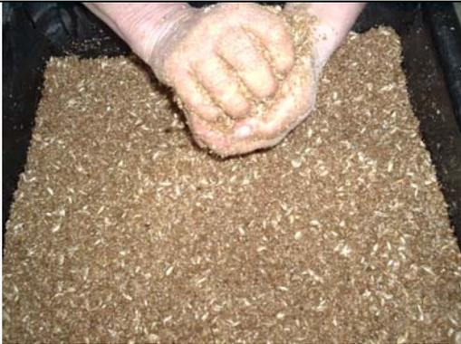
Die Vermischung ist deshalb von Hand durchzuführen, damit das Mischgut möglichst gleichmässig feucht wird. Dabei ist auf eine möglichst **klumpenfreie Mischung zu achten**, um eine ungleichmässige Feuchtigkeit zu vermeiden = qualitätsbeeinflussend.
